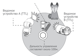
Съемка в режиме автовспышки с двумя ведомыми устройствами
