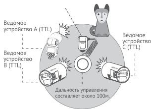
Съемка в режиме автовспышки с тремя ведомыми устройствами
