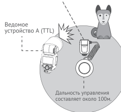
Съемка в режиме автовспышки с одним ведомым устройством
